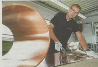
Stelzer-Mitarbeiter Patrik Neu schneidet Blech für eine Gaube zu.
