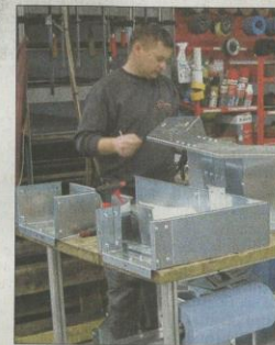
Einer der Mitarbeiter bei Stelzer baut Verkleidungen für Sondermaschinen.
