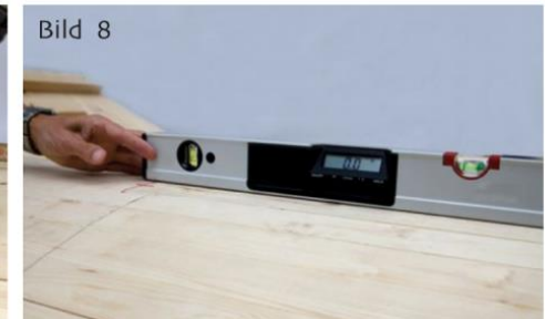
Prüfen ob der First waagrecht ist. (Abweichungen im Formblatt vermerken).
